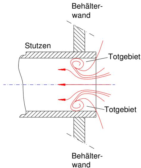
Die Einschnürung und die damit verbundene Querschnittsverengung ist aber nur die eine Hälfte des Problems. Die Geschwindigkeit der Strömung in der Einschnürung ist höher, als die Geschwindigkeit der Strömung in der Rohrleitung. (siehe auch Kapitel Theorie, Kontinuitätsgleichung) Die schnelle Strömung und die langsame Strömung prallen in und hinter der Blende aufeinander, was zu Verlust an Energie führt.
